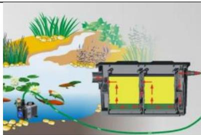
**БИОФИЛЬТР** (биологический фильтр) - сооружение для биологической очистки сточных вод, построенное на принципе постепенного прохождения очищаемых масс либо через толщу фильтрующего материала, покрытого активной микробиологической плёнкой, либо через пространство, занятое искусственно созданным сообществом организмов-очистителей, напр. камышей.
